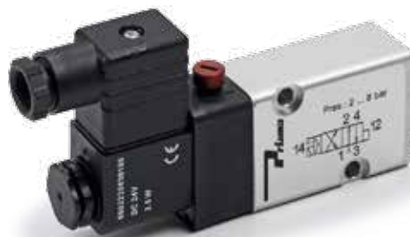
ソレノイドバルブ – アクチュエータに取り付け て、電力・空圧作動ボールバルブを形成。DC 24V、2.5W、複動式およびスプリングリターン 用 4/2方向型。IP65防塵防滴性能対応 オプション: 110VAC、50HZ。 オプション: 3/2、5/2方向型。
