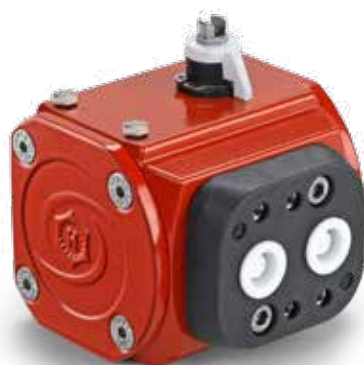
標準90°作動アルミニウム製空圧 アクチュエータ 作動圧力: 最大 8 bar (116 PSI)。標準使用 温度: -32°C~90°C (-25.6°F~194°F)
