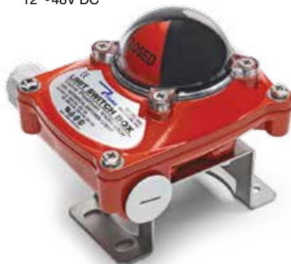
エレクトロメカニカルリミットスイッチ アクチュエータ位置の視覚的・電氣的開閉指示器。 IP67防塵防滴性能対応 電圧: AC: 250V 16A、125V 16A DC: 250V 0.3A、125V 0.6A、30V 10V
